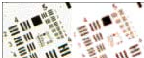
Die Auflösung des Plustek OpticFilm (links) ist deutlich höher als die des Reflecta xScan (rechts).
